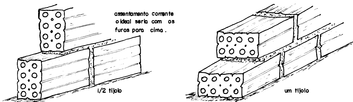
Figura 1 - Execução de alvenaria utilizando tijolos furados.
